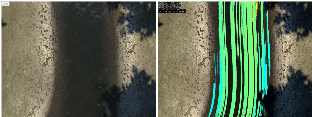
Sono riportati 2 frame tratti da il video 6 del test effettuato dal laureando Riccardo Turra. Entrambi i frame sono estrapolati al secondo 22, il primo è tratto dal video originale e il secondo è frutto delle operazioni di tracciamento dell'algoritmo OTV.
